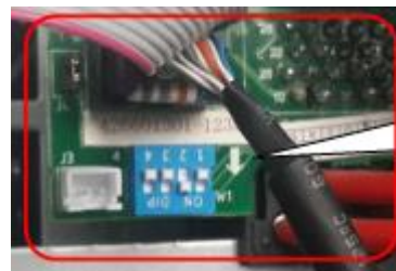
Рисунок 2. Дип переключатель для установки адреса силового модуля
