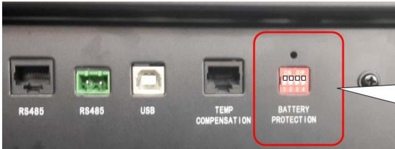
Рисунок 3 DIP-переключатель числа батарей.
