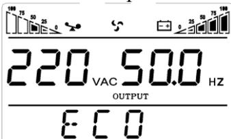
Если функция экономии энергии ECO включена, и параметры входной сети в норме (частота и напряжение находятся в допустимых для режима ECO пределах - внутри байпасного диапазона). ИБП будет работать в экономичном режиме с увеличенным КПД. Если напряжение в сети вышло за пределы байпасного входного диапазона, но ещё находится в пределах стандартного входного диапазона ИБП, ИБП перейдёт в сетевой инверторный режим автоматически.
