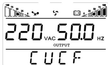
Режим конвертора частоты предназначен в основном, для обеспечения стабильной частоты и напряжения на выходе.
