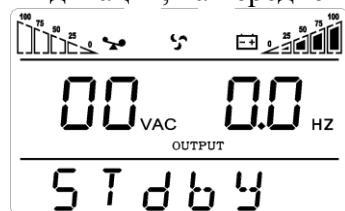
Экран показывает что напряжение на выходе ИБП равно нулю.
