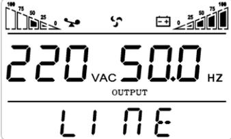
Если входная сеть в норме (частота и напряжение входной сети находятся в допустимых пределах), ИБП работает в сетевом режиме.
